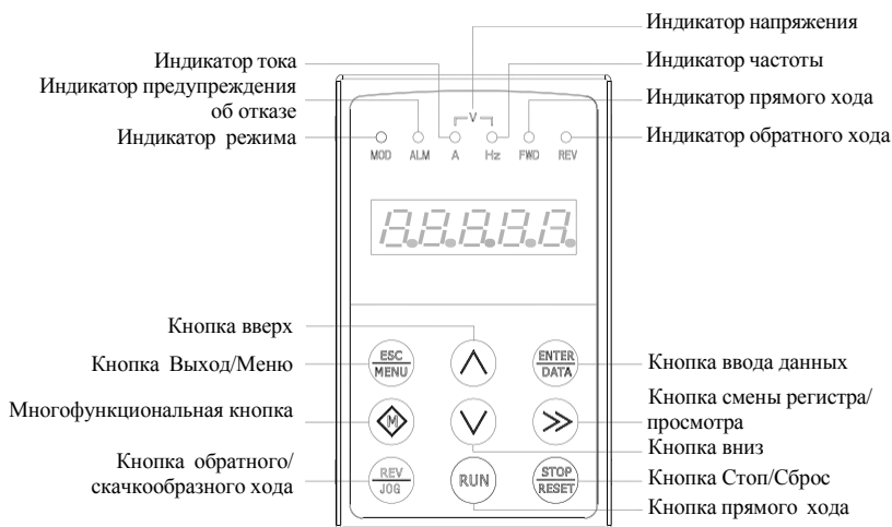
Рис. 5-2 Схема пульта управления
