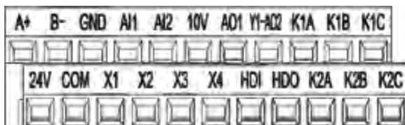
Рис 2-4 Схема расположения клемм цепи управления
