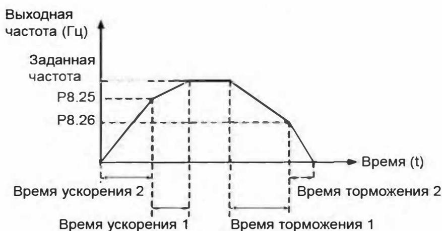
ускорения/торможения в течение процесса работы преобразователя исходя из изменения рабочей частоты, а не с помощью дискретных входов DI.
