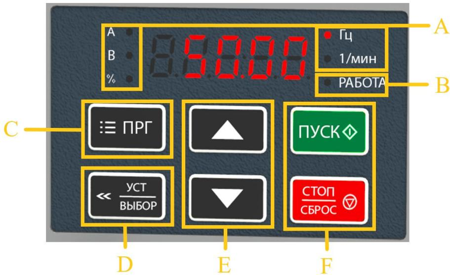
Рис.4-3. Панель управления преобразователя частоты
